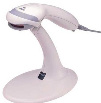
Рис 12. Однолучевой сканер Metrologic на подставке
