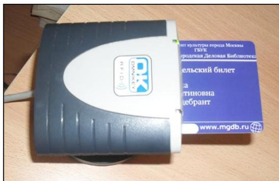
Рис. 17. Считыватель читательского билета
